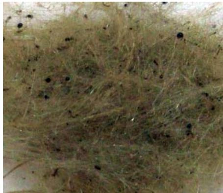
**Abbildung 1-1** Fotografie des in Kernkraftwerken zur Isolierung von Rohrleitungen eingesetzten faserförmigen Isolationsmaterials
